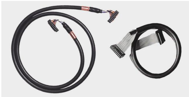
Соединительные кабели используются для подключения фронтальных соединителей SIMATIC TOP Connect к терминальным модулям. Для этой цели используется ленточный кабель 1x16 жил (обычный или экранированный) или 2x16 жил (обычный) с одним или двумя плоскими соединителями на каждом конце. Ленточный кабель помещен в защитную оболочку, повышающую стойкость кабеля к внешним воздействиям.
