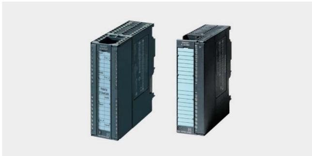
Модули ввода аналоговых сигналов SM 331 предназначены для подключения к контроллеру аналоговых датчиков, выполнения аналого-цифрового преобразования входных аналоговых сигналов и формирования цифровых величин, используемых центральным процессором в ходе выполнения программы. К входам модулей могут подключаться датчики с унифицированными выходными электрическими сигналами
