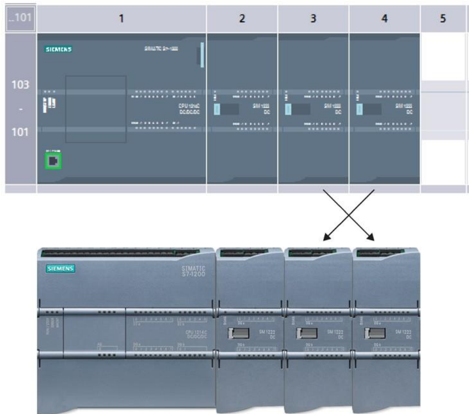
Рисунок 6-3 Конфигурация устройства в сравнении с реальной установкой, где модули в слотах 3 и 4 поменяны местами
