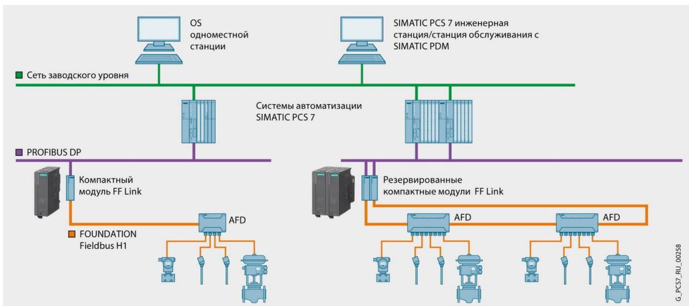
Сети полевого уровня PROFIBUS PA и FOUNDATION Fieldbus H1 (FF H1) соответствуют требованиям международного стандарта IEC 61158-2 и используют для своей работы метод MBP (Manchester Coded; Bus Powered). Обмен данными со скоростью 31.25 кбит/с и питание узлов сети осуществляется через один экранированный двухпроводной кабель.
