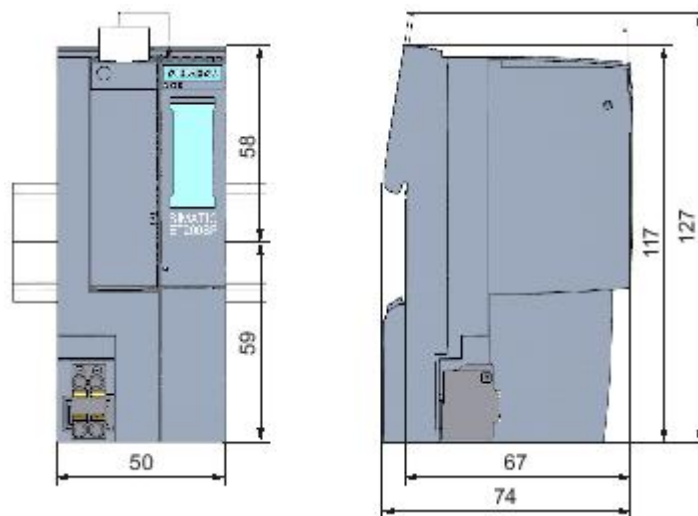
Рисунок 8-8 Габаритные размеры интерфейсного модуля IM 155-6 PN ST
